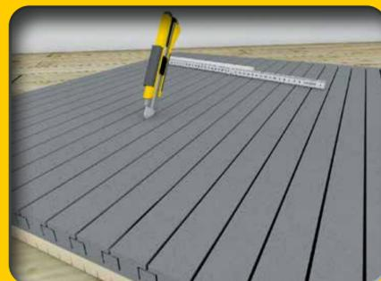
Rollladenkasten-Dämmungen individuell kürzen oder erweitern.
